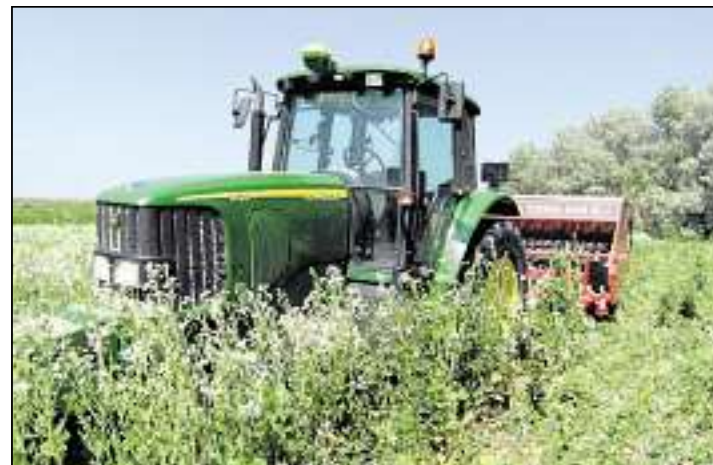
Le tracteur écrase la couverture végétale, tout en tractant le semoir.
