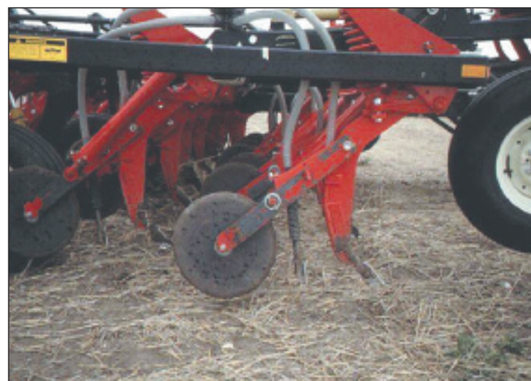
Détails d'un semoir en semis direct à dents avec localisateurs d'engrais.
